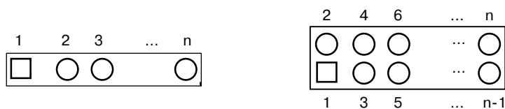
Рис. 17. Типовое расположение контактов разъемов и переключателей IDC-типа. Первый контакт имеет квадратную форму печатной площадки.
