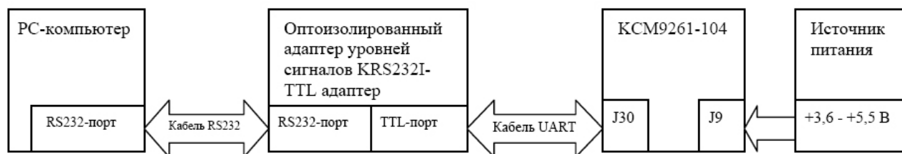
Рис. 27-1. Структурная схема подключения компьютера для отладки и программирования через RS232-интерфейс.
