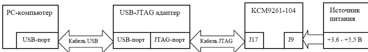
Рис. 26-1. Структурная схема подключения контроллера для отладки и программирования через JTAG-интерфейс.
