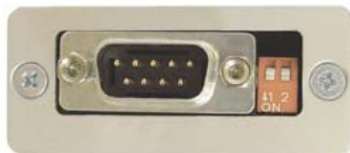
Рис. 4 CAN-разъем и переключатель нагрузочного резистора на боковой стороне корпуса адаптера.
